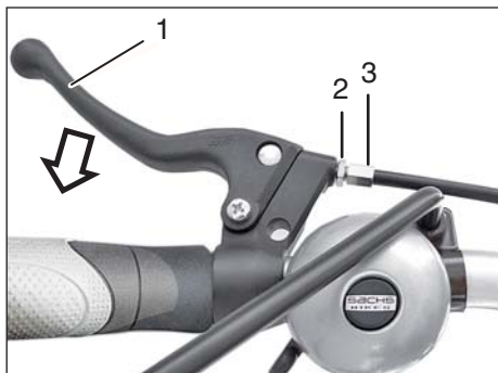
Handbremshebel (1) für Hinterradbremse ohne Rücktrittbremse
